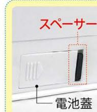
ボタン電池の**誤飲防止対策**で、電池蓋の溝に**ゴム製スペーサー**(黒色)を差し込み、お子様が簡単に蓋を開けられないようにしています。電池交換の際は、スペーサーを外してから蓋を開けてください。電池交換後は蓋を閉じてから、元の位置にスペーサーを差し込んでください。
